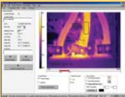
Capture imágenes térmicas claras y analice fácilmente los datos radiométricos (temperatura) de cada uno de los 19,200 píxeles.
